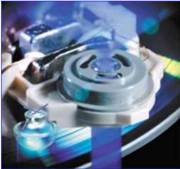
Double lentille développée par Philips Research pour le Blu-ray Disc
